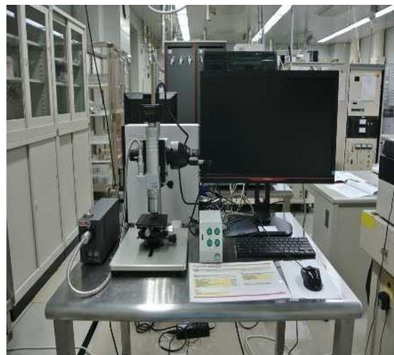
デジタルマイクロスコープ ：高精細画像での観察、計測、記録
